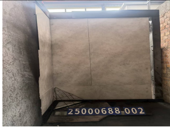
Burning performance - Before test(EN 13823)
